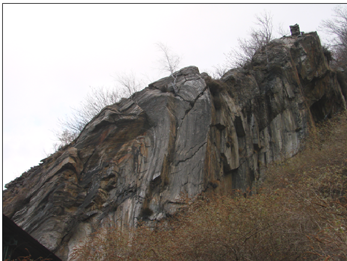
Figura 10: immagine fotografica del settore di ammasso roccioso con deformazione di tipo antiforme.
