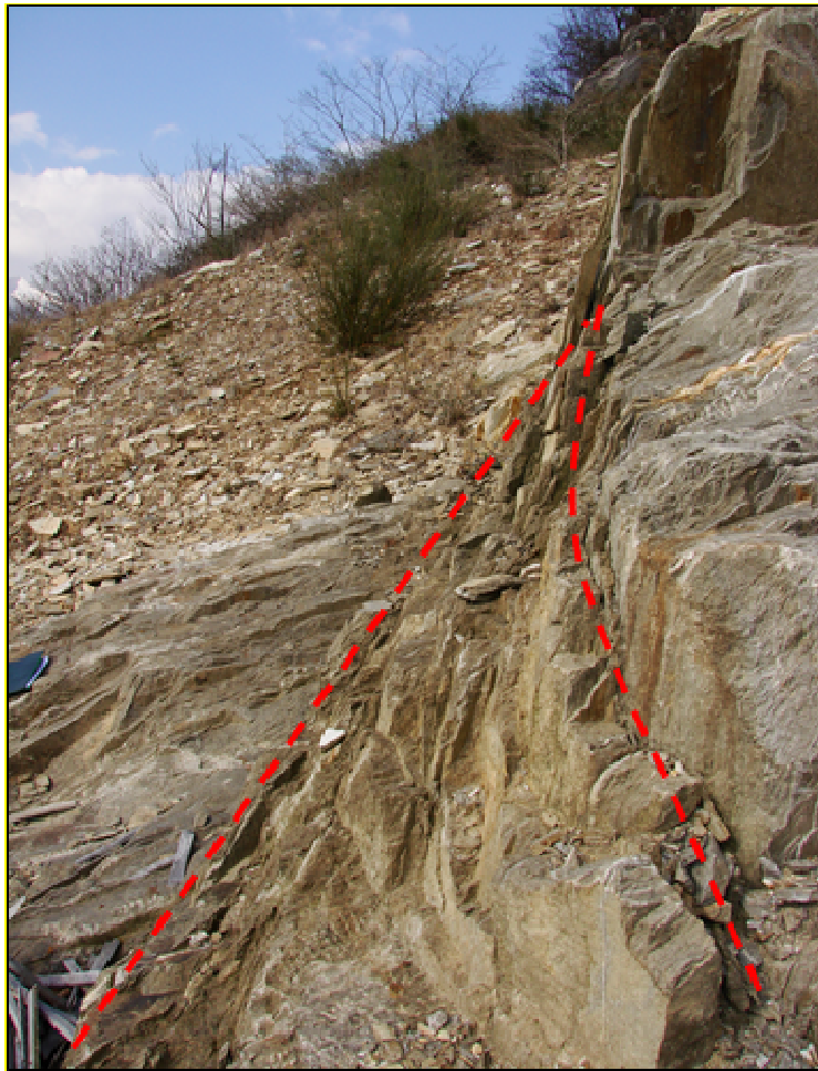
Figura 12: immagine fotografica dell’ammasso roccioso in cui si riconosce una deformazione di tipo cataclastico.
